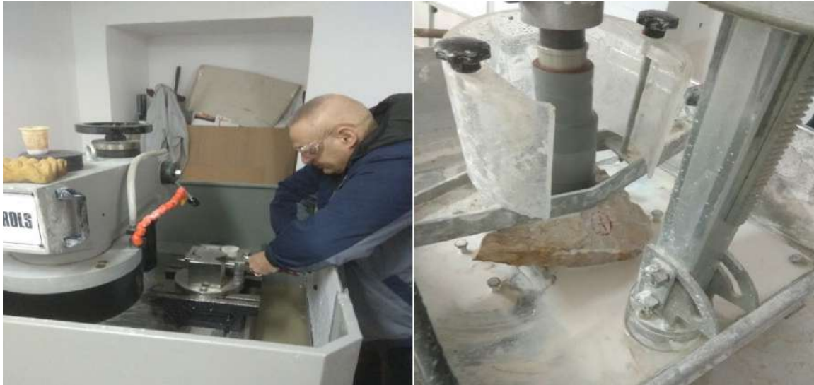
Figura 4-5 Përgatitja e kampionit për rezistencën në shtypjen një boshtore
