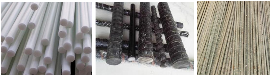
Figura 2. 1 Shembuj të tipeve të shufrave përforcuara FRP
