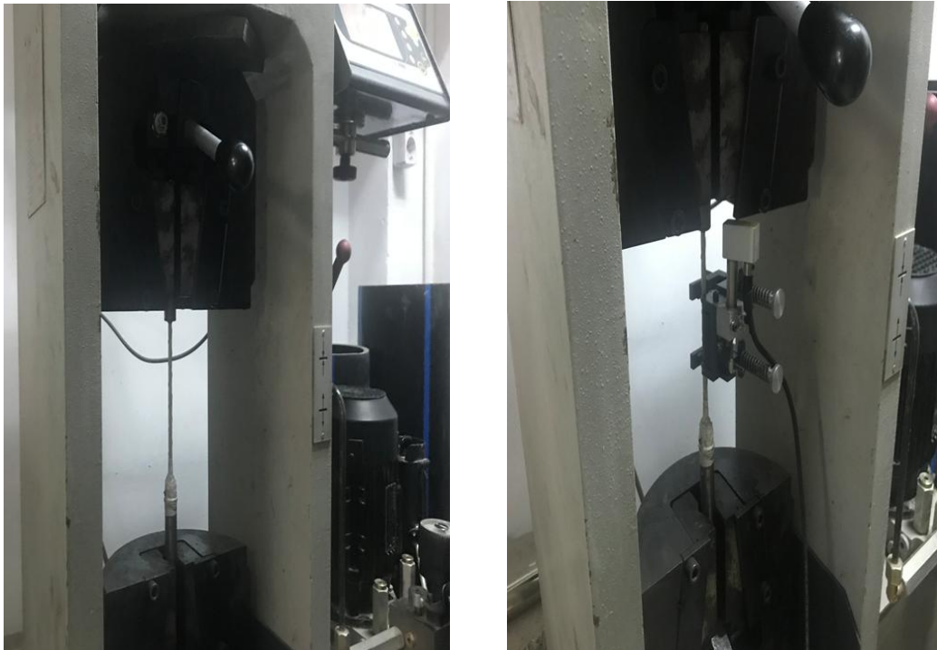
Figura 4.5. Makineria e përdorur për provat në tërheqje të shufrave GFRP dhe CFRP
