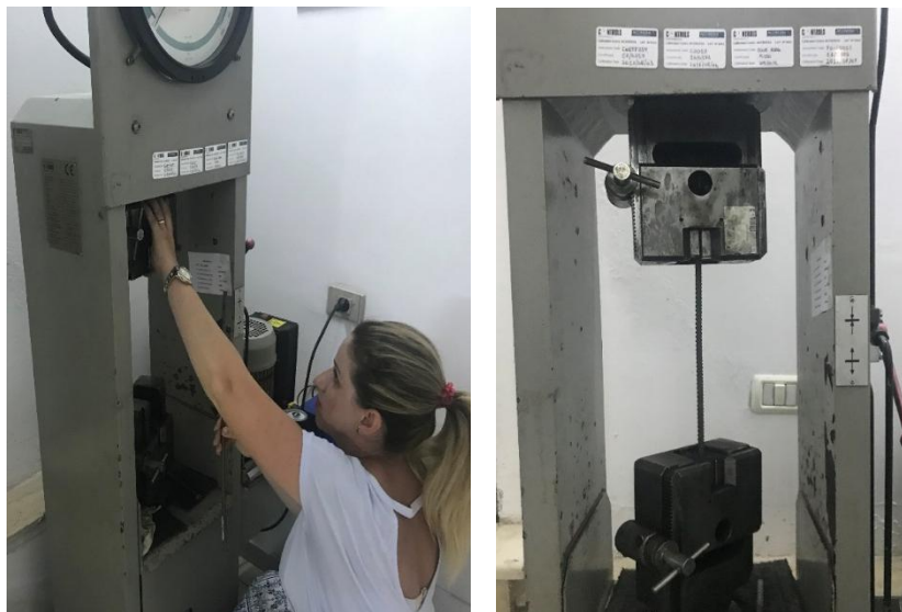
Figura 4.9. Montimi shufrës çelikut \Phi 10mm në pajisjen testuese në tërheqje
