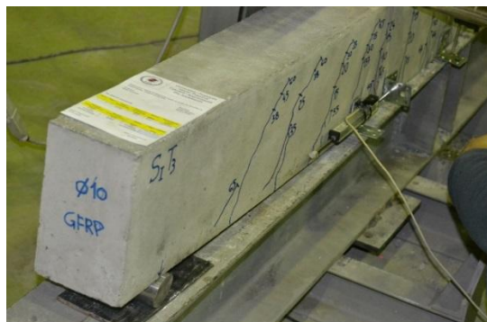
Figura. 4.35. Trau T3 i armuar me 2 shufra Ø10 GFRP
