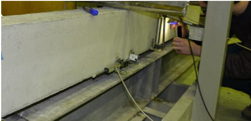
Figura 4.37. Trau T4 i armuar me 2 shufra shufra Ø8 CFRP)
