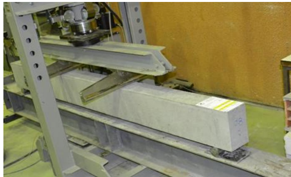
Figura 4.43. Trau T6 i armuar me armaturë konvencionale 2Ø8mm
