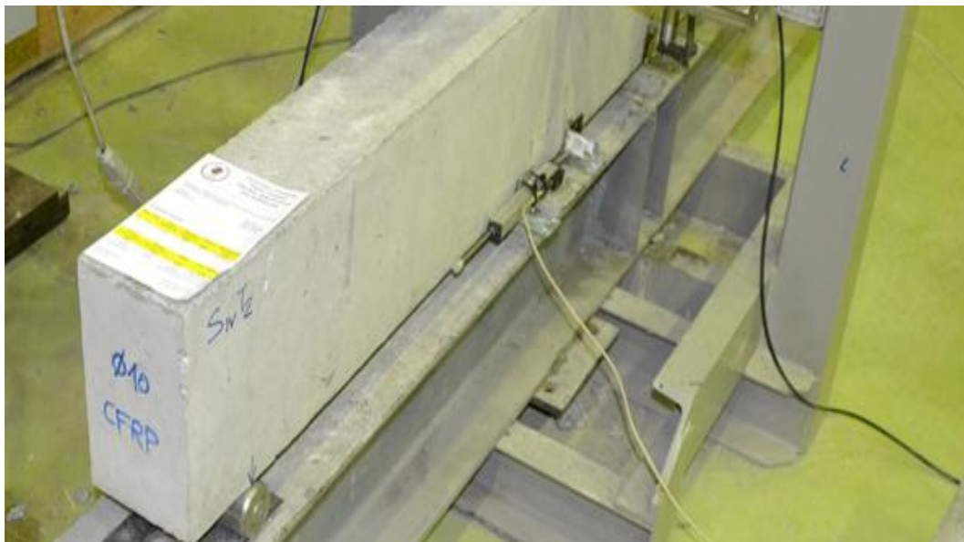
Figura 4.40. Trau T5 i armuar me 2 shufra Ø10 të përforcuara me fibra CFRP
