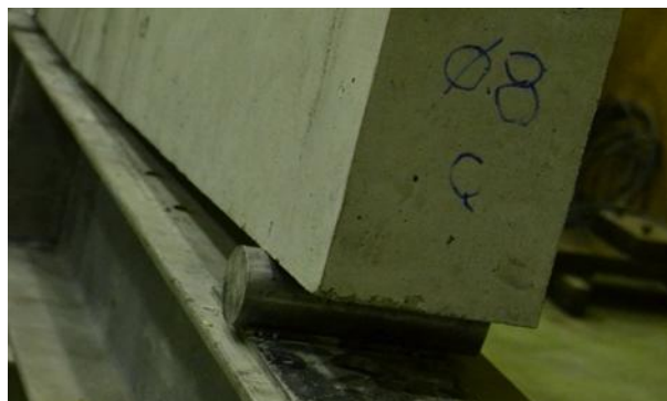
Figura 4.44. Trau T6 i armuar me armaturë konvencionale 2Ø8mm
