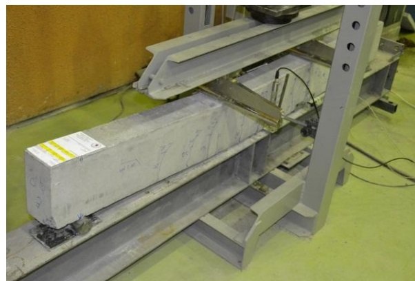
Figura 4. 46 . Trau T7 i armuar me armaturë konvencionale 2 Ø10 mm
