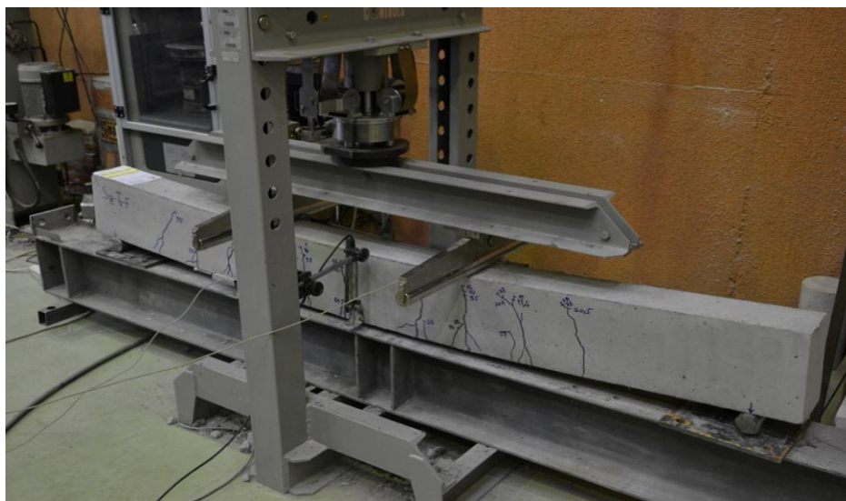
Figura 4.123. Uljet dhe plasaritjet e zhvilluara në trarët e eksperimentuar me ngarkesa
