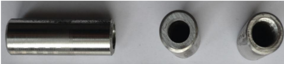
Figura 4.2. Detaje metalike të përdorura për fiksimin e shufrave FRP në këtë studim
