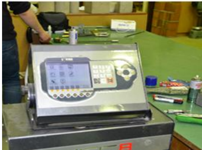
Figura 4.24. Pajisja regjistruese e të dhënave gjatë eksperimentimit të trarëve
