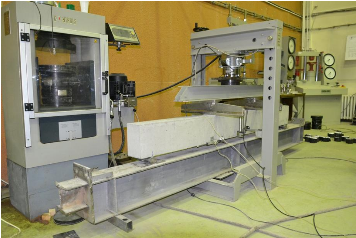
Figura 4.23. Pajisja me ID MCC8 për ngarkimin e trarëve të armuar me fibra FRP dhe armature konvencionale
