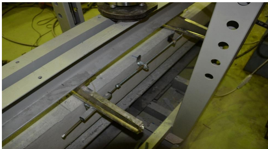
Figura 4.30. Pozicioni i vendosjes së estensometrit për matjen e deformimeve të betonit
