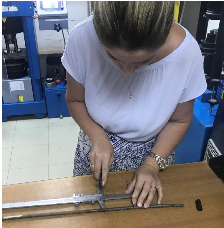
Figura 4.8. Fiksimi i gjatësisë L_0 për matjen e zgjatimit relative të shufrës çelikut \Phi 10mm
