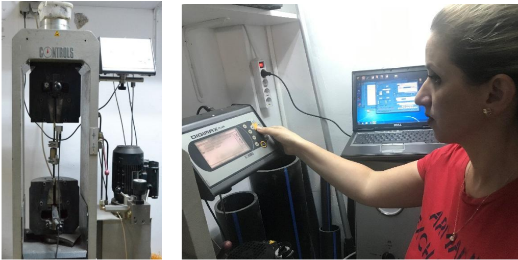
Figura 4.4. Paisja e përdorur për provat në tërheqje të shufrave GFRP dhe CFRP
