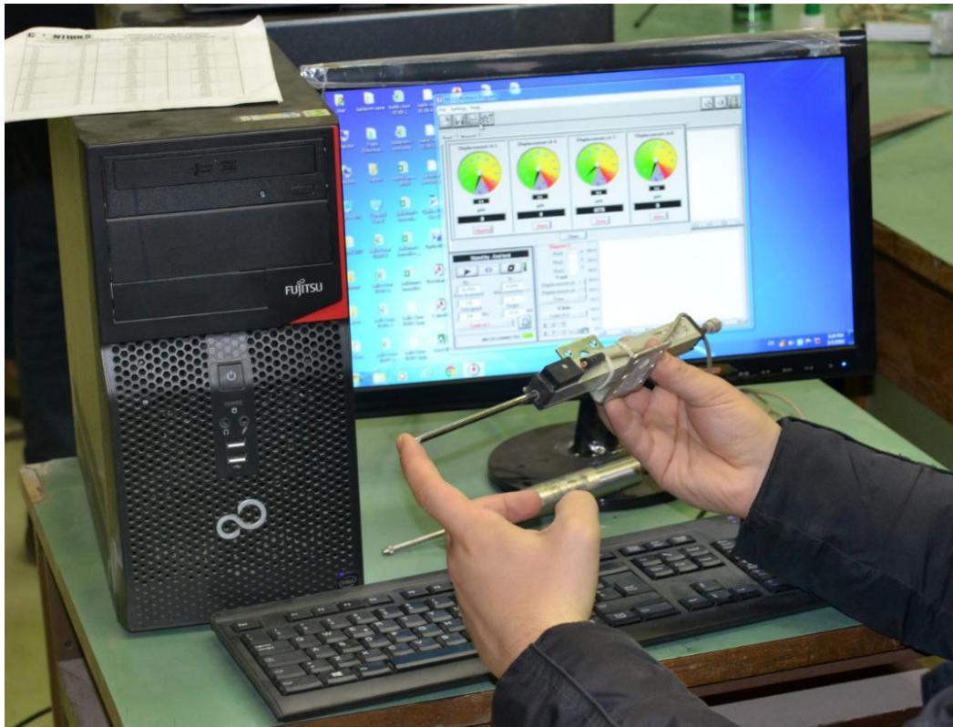
Figura 4.22. Kalibrimi i estensometrave para fillimit të provës me ngarkesë
