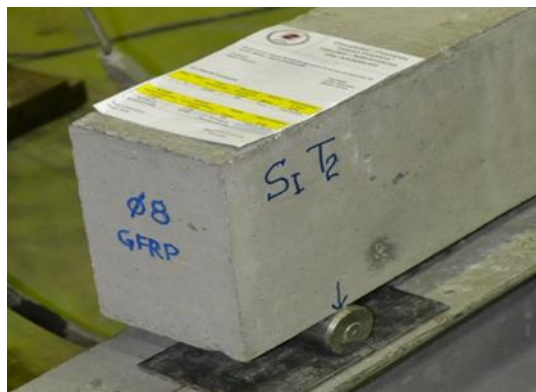
Figura 4.33. Seti I trarëve T2 i armuar me 2 shufra Ø8mm të përforcuara me fibra qelqi (GFRP)
