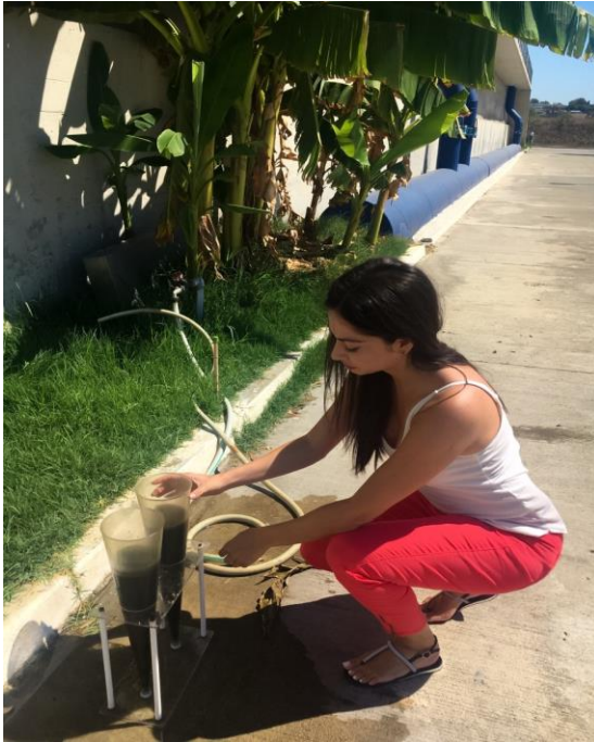
Figura 12 Pamje nga kryerja e analizave në ITUND me kon Imhoff
