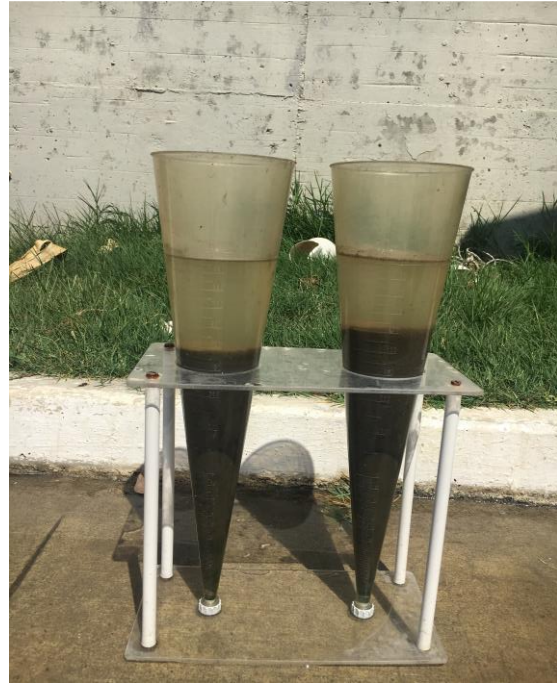
Figura 12 Pamje nga kryerja e analizave në ITUND me kon Imhoff
