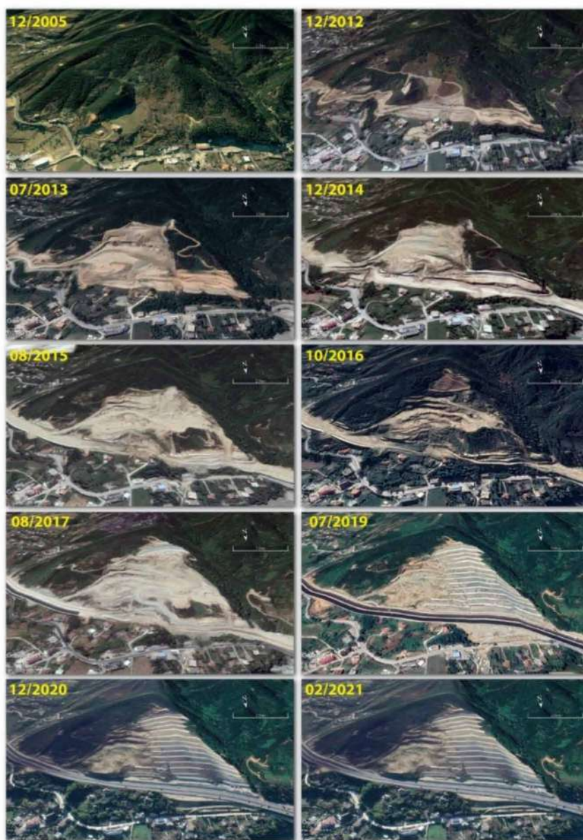
Figura 2.12 Imazhe nga Google Earth për periudha të ndryshme kohore që tregojnë rrëshqitjen e Ibës.
